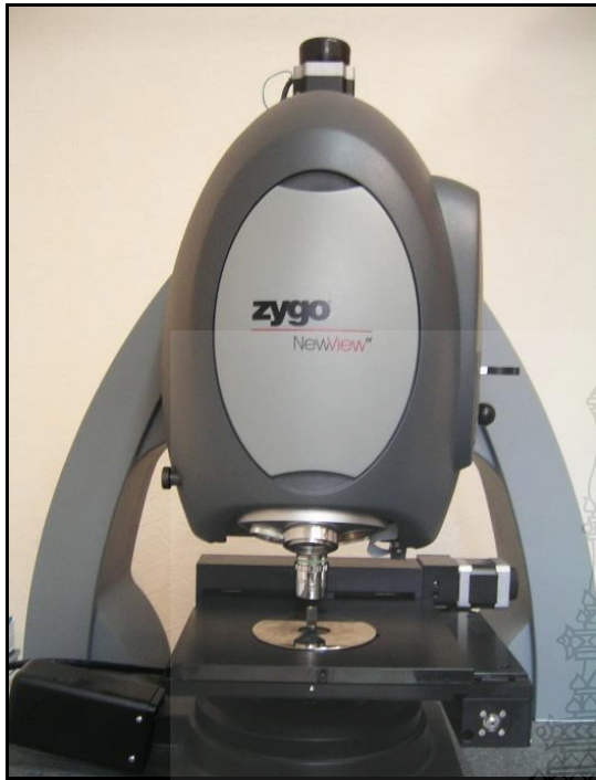
า) ลักษณะของเครื่อง Optical Profilometer
