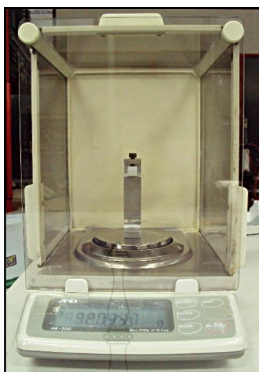
รูปที่ 3.21 เครื่องชั่งน้ำหนัก AND รุ่น HR-200 ความละเอียด 0.1 mg
