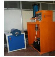
รูปที่ 1 เครื่อง Ram Extruder และการอัดรีดขึ้นรูป
