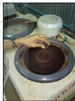
(ค) การขัดชิ้นงานทดสอบด้วยผ้าสักหลาด
