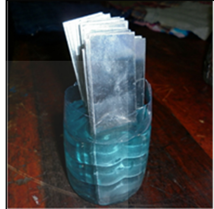
(ข) แผ่นอลูมิเนียม AA1100 นั้น เช็ดทำความสะอาดด้วยอะซิโตน
