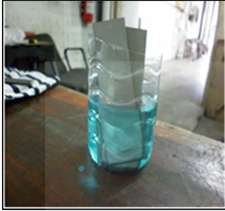
(ก) แผ่นเหล็กกล้าเคลือบสังกะสี SGACD จะทำความสะอาดด้วยเอทิลแอลกอฮอล์
