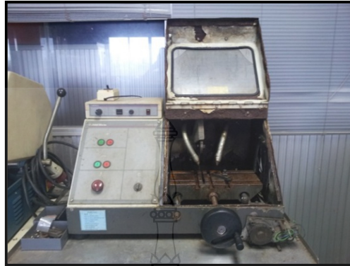
รูปที่ 3.21 การเตรียมชิ้นงานเพื่อการทำเรื่อน (Mounting)
