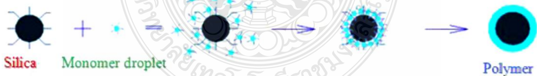
ภาพที่ 2.6 การเอนแคปซูเลชันด้วยการสังเคราะห์แบบอินซิทู [27]
