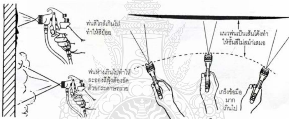
ภาพที่ 2.21 วิธีการพ่นสี ระยะห่างการเคลื่อนที่พ่นพ่นสีที่ไม่ถูกต้อง
