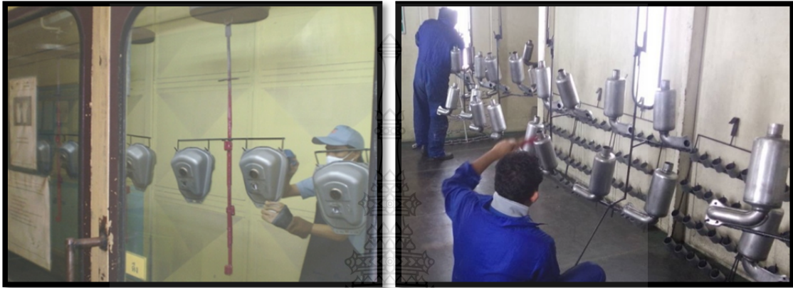
ภาพที่ 3.4 ขั้นตอนการเป่าน้ำ (Air Blow) และ Masking ใส่อุปกรณ์ปิดบังไม่ให้สีติด
