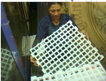
รูปที่ 5 แสดงการตรวจสอบชิ้นงานด้วยสายตา (Visual check)
