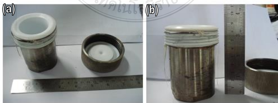
รูปที่ 3.2 (a) และ (b) ลักษณะของถังปฏิกรณ์ (Autoclave) ซึ่งปริมาตรขนาด 80 มิลลิลิตร
