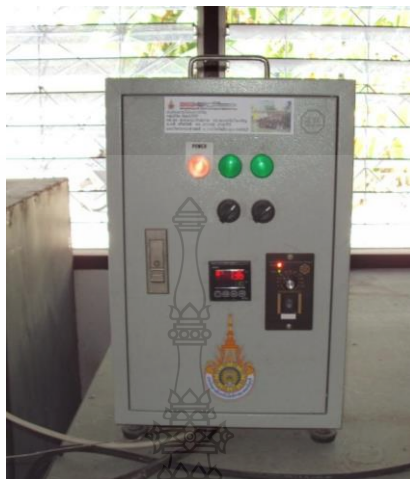
รูปที่ 3.10 ชุดควบคุมการทำงานของเครื่องสังเคราะห์
