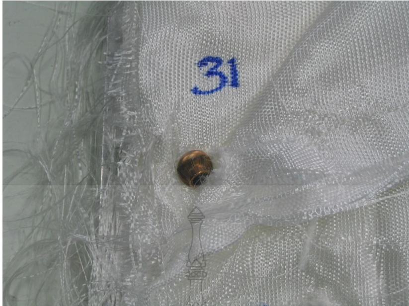
รูปที่ 4.40 ตรวจสอบจำนวนชั้นทะลุของ แผ่นเกราะแบบไม่เย็บแรงอัด 800 กก.แรง กระสุนทะลุพื้นผ้าได้ 31 ชั้น
