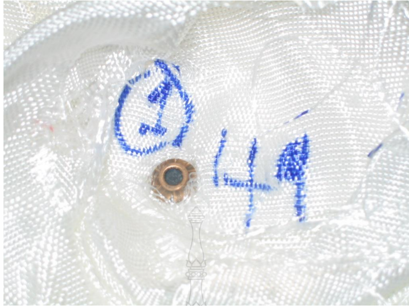
รูปที่ 4.34 ตรวจสอบจำนวนชั้นทะลุของกระสุนนัดที่ 1 แผ่นเกราะแบบไม่เย็บ กระสุนทะลุพื้นผ้าได้ 49 ชั้น
