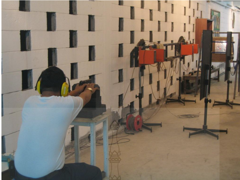
รูปที่ 3.39 ยิงตัวอย่างแผ่นเกราะ ด้วยกระสุนปืน 9 มม.
