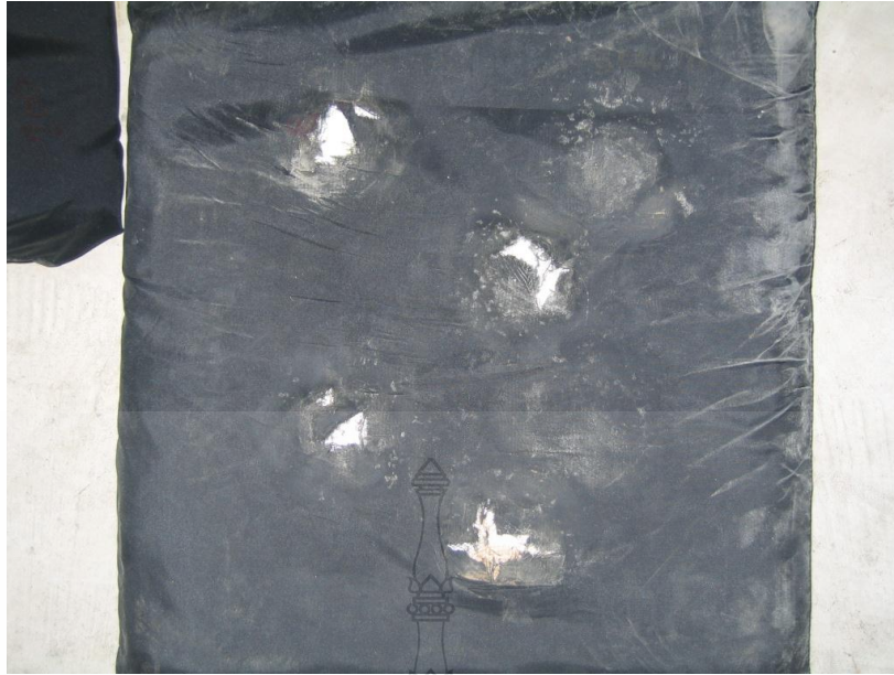
รูปที่ 4.13 ด้านหลังแผ่นเกราะระดับ 3A ยิงด้วย 5.56 และ 7.62 มม.
