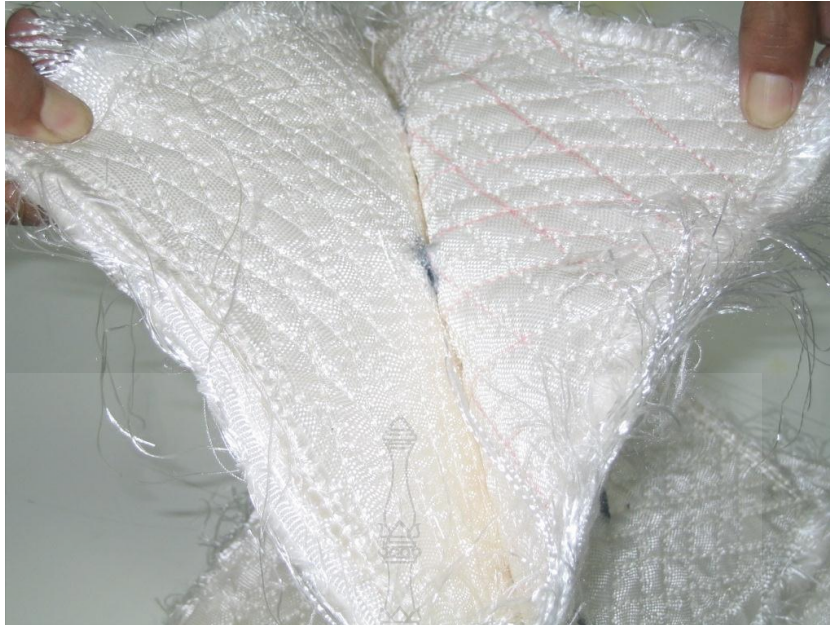
รูปที่ 4.9 ตรวจสอบจำนวนชั้นของ แผ่นเกราะ 3 A ที่ทะเลจากการ ยิงด้วย 5.56 และ 7.62 มม.
