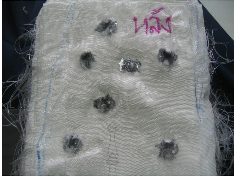
รูปที่ 4.15 แผ่นเกราะแข็งแผ่นที่ 200 (แผ่นสุดท้าย) ยิงด้วย 5.56 และ 7.62 มม.
