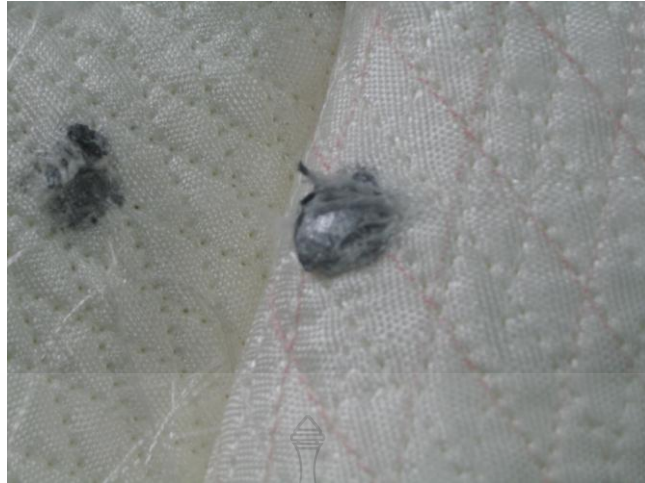
รูปที่ 4.17 หัวกระสุน 7.62 มม. ทะลุแผ่นเกราะ 3 A
