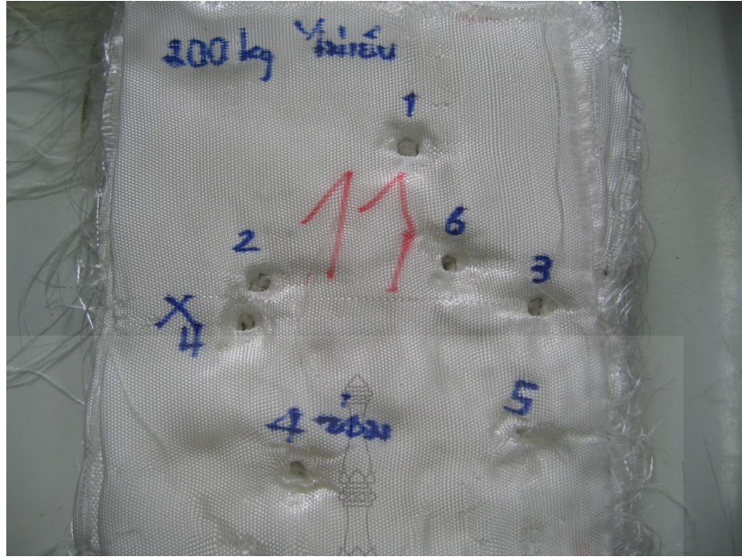
รูปที่ 4.30 แผ่นเกราะแบบไม่เย็บด้านหน้า ถอดแผ่นอลูมิเนียมแล้ว หลังทดสอบยิงด้วยกระสุนปืน 9 มม. นัดที่ 4 มีการยิงซ่อม เนื่องจากระยะห่างระหว่างนัดไม่ได้ตามเกณฑ์มาตรฐาน
