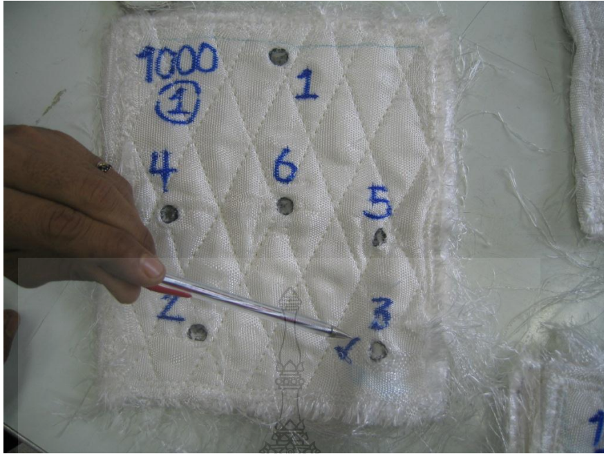
รูปที่ 4.28 แผ่นเกราะแบบเย็บ แรงอัด 1000 กก.แรง หลังยิงทดสอบ
