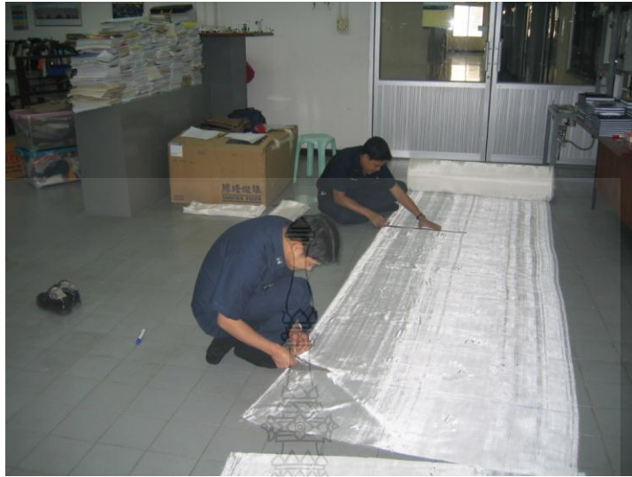
รูปที่ 3.21 การตัดผ้าไนลอน 66 ตามแบบชิ้นทดสอบ
