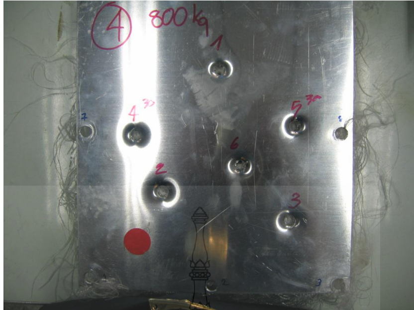
รูปที่ 4.38 แผ่นเกราะแบบไม่เย็บ แรงอัด 800 กก.แรง หลังยิงทดสอบ
