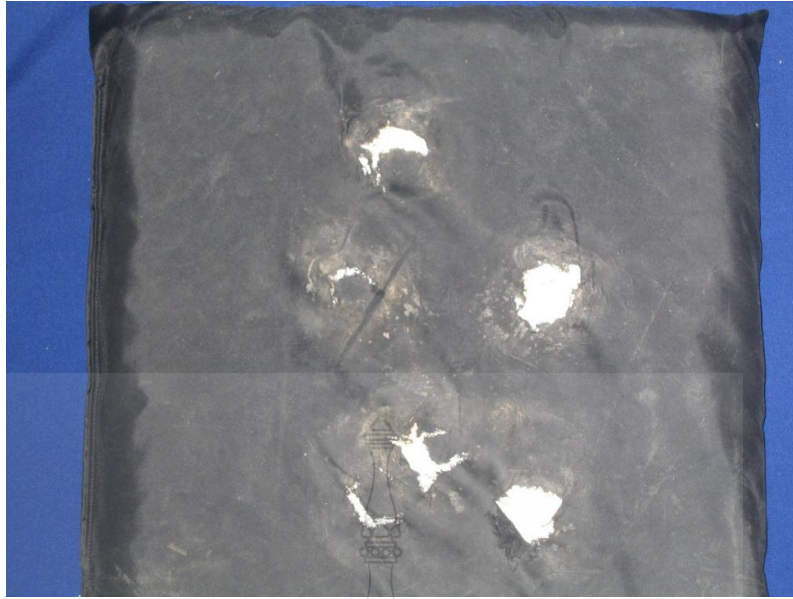
รูปที่ 4.7 แผ่นเกราะ 3A ด้านหลัง ร่องแผ่นเกราะแข็ง ยิงด้วย 5.56 และ 7.62 มม.
