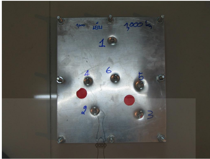
รูปที่ 3.41 ตัวอย่างแผ่นเกราะแบบเหวี่ยง แรงอัด 1000 กก.แรง หลังทดสอบยิง
