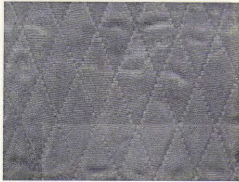
รูปภาพที่ 4 รูปแบบลายเส้นเป็นรูปขมมเปือกปูน ขนาดประมาณ 1 นิ้ว เส้นเป็นเส้นทแยงมุม ตามแนวการวางผืนผ้า
