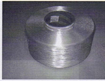
รูปภาพที่ 1 เส้นด้ายไบนลอน 66 ความเหนียวสูง
