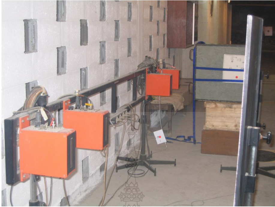
รูปที่ 3.8 เครื่องวัดความเร็วกระสุนปืนของกรมสรรพาวุธทหารอากาศ
