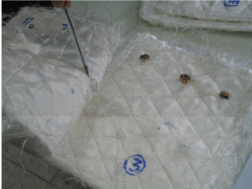
รูปที่ 3.45 แผ่นเกราะแบบเย็บหลังเลาะเส้นด้าย
