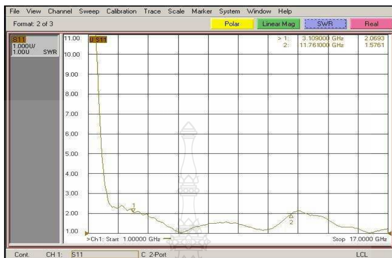
ภาพที่ 4.5 ผลการวัดอัตราส่วนแรงดันคลื่นนิ่งของสายอากาศแบบระนาบร่วมช่องปลายเปิดรูปเขา เขากวางสำหรับการประยุกต์ใช้งานย่านความถี่กว้างยิ่ง
