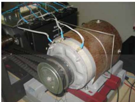
รูปที่ 5 แสดงการติดตั้งชุดเซนเซอร์อุณหภูมิ และอุปกรณ์บังคับทิศทางลมระบายความร้อน
