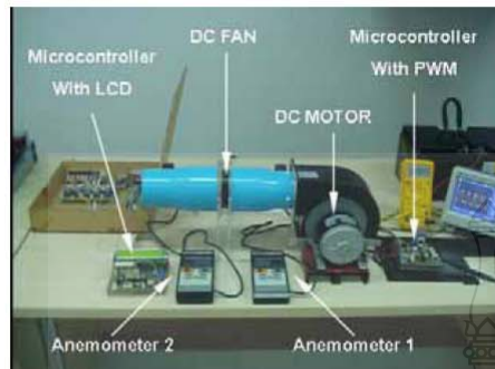
รูปที่ 8 แสดงการทดสอบเปรียบเทียบระหว่างการแสดงผลของจอ LCD จากการประมวลผลของไมโครคอนโทรลเลอร์กับเครื่องวัดความเร็วลมจำนวน 2 ชุด ด้วยชุดอุปกรณ์
