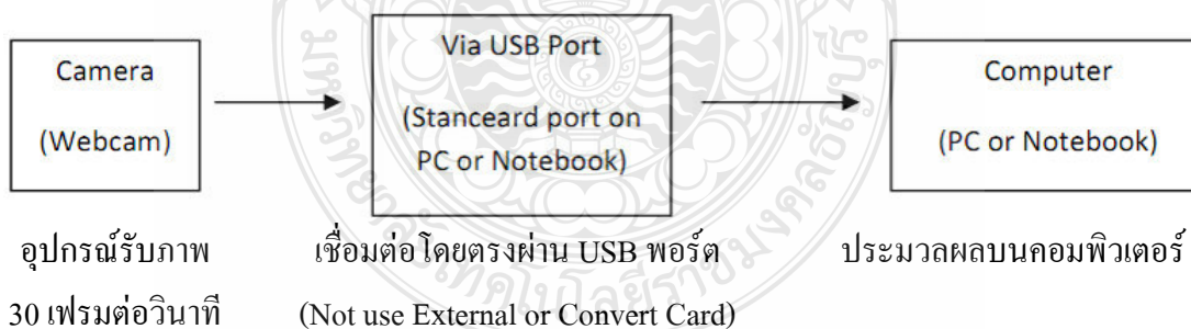
ภาพที่ 2.23 การเชื่อมต่อการรับภาพจากกล้อง Webcam
