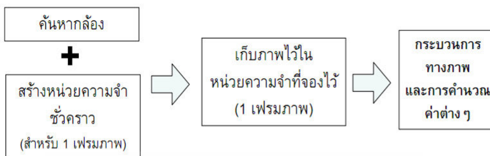
ภาพที่ 2.22 ขั้นตอนในฟังก์ชันการถ่ายภาพในโปรแกรม LabVIEW
