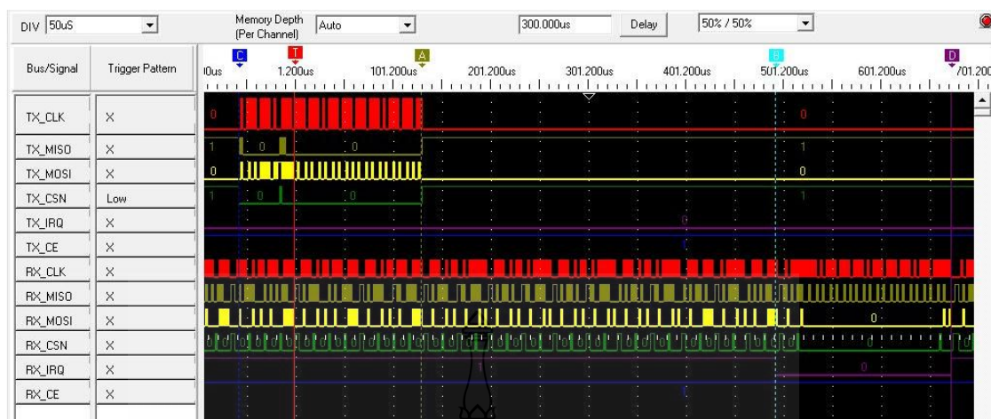
ภาพที่ 4.10 วัดสัญญาณ SPI ระหว่างการรับ-ส่งข้อมูลไร้สายทั้งโมดูลตัวส่งและโมดูลตัวรับ
