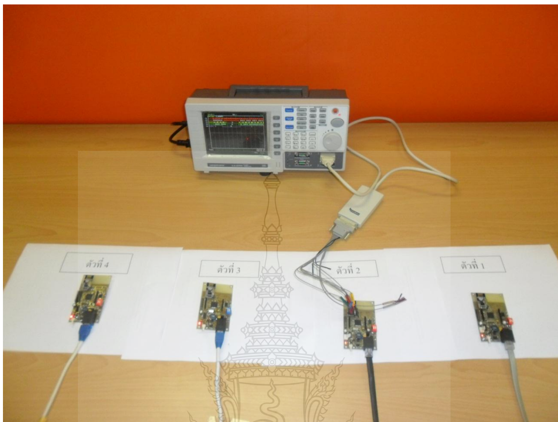
ภาพที่ 4.8 การทดสอบ โมดูล 4 ชุดในระยะใกล้กัน
