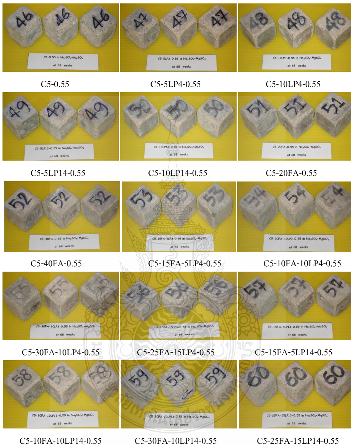
ภาพที่ 4.83 ภาพถ่ายชิ้นตัวอย่างมอร์ตาร์ปูนซีเมนต์พอร์ตแลนด์ประเภทที่ 5 ผสมฝุ่นหินปูนและเถ้าลอย ที่อัตราส่วนน้ำต่อวัสดุประสานเท่ากับ 0.55 ในสารละลายโซเดียมซัลเฟตผสมแมกนีเซียมซัลเฟต (3:1) ที่อายุ 476 วัน (68 สัปดาห์)
