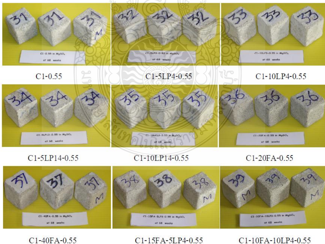
ภาพที่ 4.77 เปรียบเทียบการการสูญเสียน้ำหนักของชิ้นตัวอย่างมอร์ต้าร์ปูนซีเมนต์ปอร์ตแลนด์ประเภทที่ 5 ผสมฝุ่นหินปูนและเถ้าลอย ที่อัตราส่วนน้ำต่อวัสดุประสานเท่ากับ 0.55 เมื่ออายุของการแช่ในสารละลายแมกนีเซียมซัลเฟต 644 วัน
