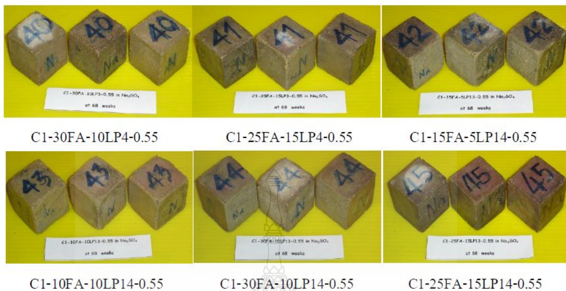
ภาพที่ 4.74 ภาพถ่ายชิ้นตัวอย่างมอร์ตาร์ปูนซีเมนต์พอร์ตแลนด์ประเภทที่ 1 ผสมฝุ่นหินปูนและเถ้าลอย ที่อัตราส่วนน้ำต่อวัสดุประสานเท่ากับ 0.55 ในสารละลายโซเดียมซัลเฟต ที่อายุ 476 วัน (68 สัปดาห์)
