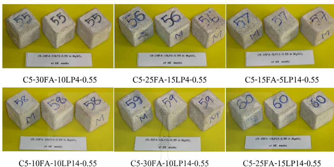
ภาพที่ 4.79 ภาพถ่ายชิ้นตัวอย่างมอร์ต้าร์ปูนซีเมนต์ปอร์ตแลนด์ประเภทที่ 5 ผสมฝุ่นหินปูนและเถ้าลอย ที่อัตราส่วนน้ำต่อวัสดุประสานเท่ากับ 0.55 ในสารละลายแมกนีเซียมซัลเฟต ที่อายุ 476 วัน (68 สัปดาห์)
