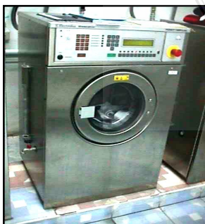
รูปที่ 3.5 เครื่องซักผ้าแบบใส่ผ้าด้านหน้า (ถังนอน) ยี่ห้อ Electrolux รุ่น Wascator/FOM71MP LAB
