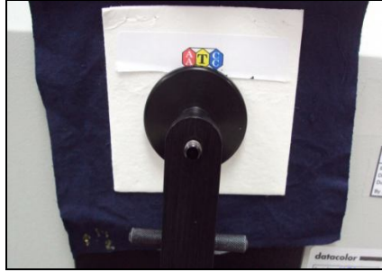
รูปที่ 3.56 การวัดสีครั้งที่ 3 กับผ้าชั้นที่ 2 โดย แนวด้ายยืนตั้งฉากกับแนวระนาบ
