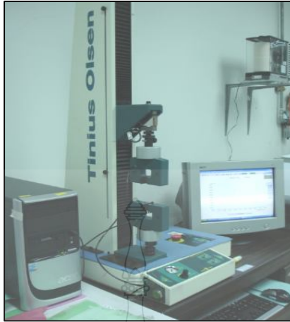
รูปที่ 3.42 เครื่องทดสอบความแข็งแรงต่อแรงดึง
