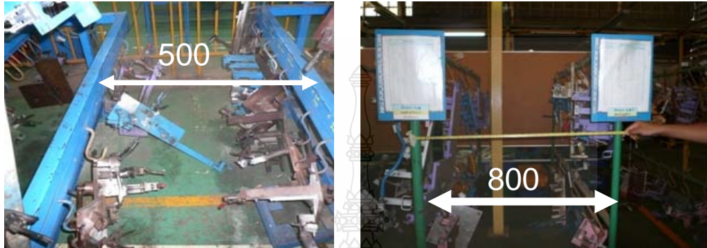
รูปที่ 4.14 ก่อนและหลังการปรับปรุงราวแขวนจิกเชื่อมบัดกรีแข็ง
