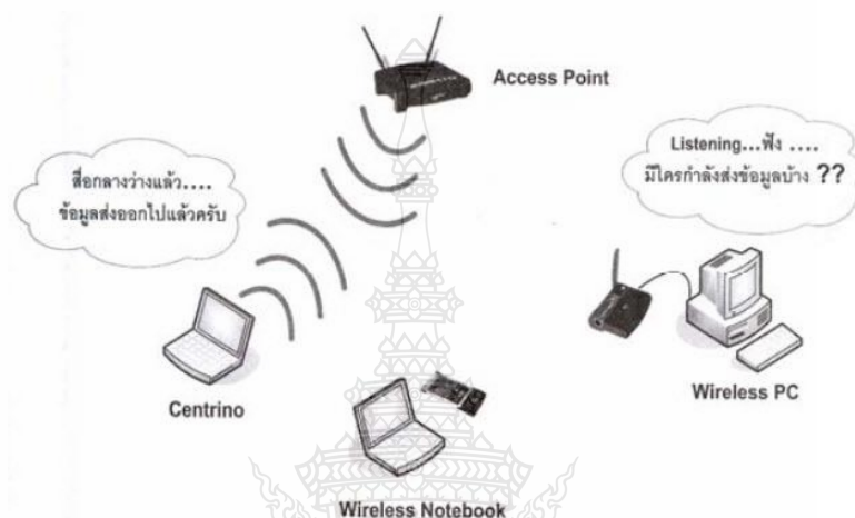
ภาพที่ 2.16 วิธีการทำงานของกลไก CSMA/CA
