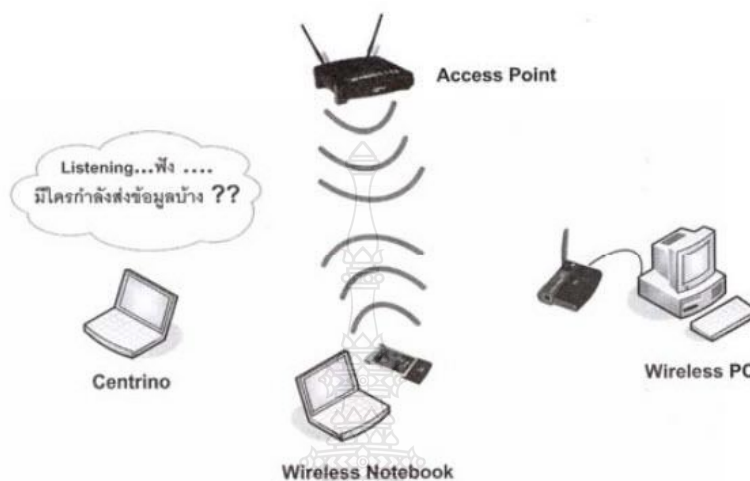
ภาพที่ 2.14 วิธีการทำงานของกลไก CSMA/CA
