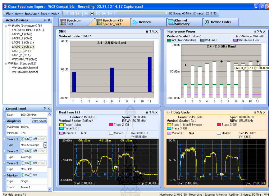
ภาพที่ 3.17 โปรแกรม Cisco Spectrum ซึ่งแสดงรายละเอียดต่างๆของสัญญาณ เช่น SNR, Interference Power, Channel utilization, FFT Duty Cycle
