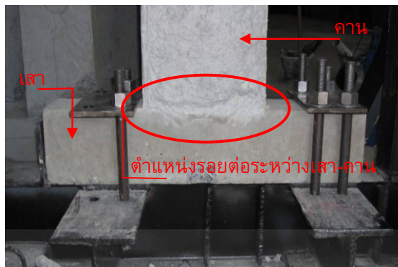
ภาพที่ 2 แท่งตัวอย่างทดสอบหาค่ากำลังเฉือน
