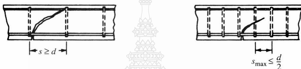
ภาพที่ 2.9 ระยะห่างสูงสุดของเหล็กปลอก [8]
