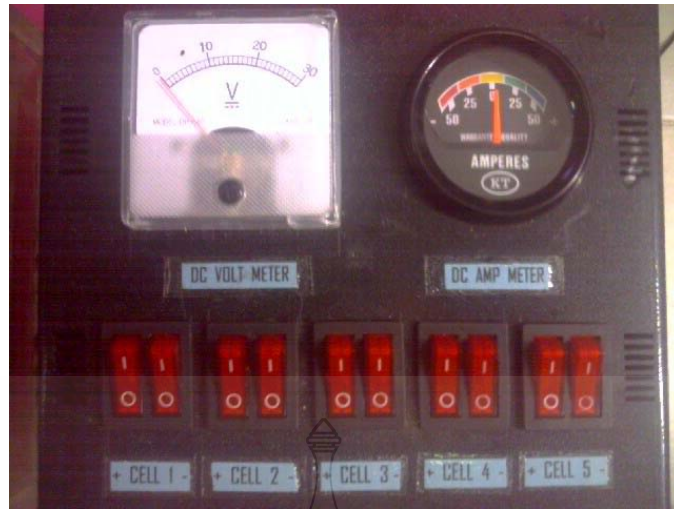
รูปที่ 3.16 ชุดควบคุมการทำงานของเซลล์แต่ละชุด
