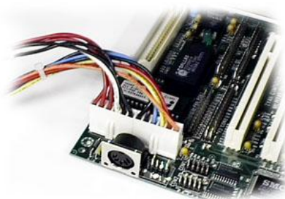
ภาพที่ 11 ขั้วต่อสายแหล่งจ่ายไฟ
