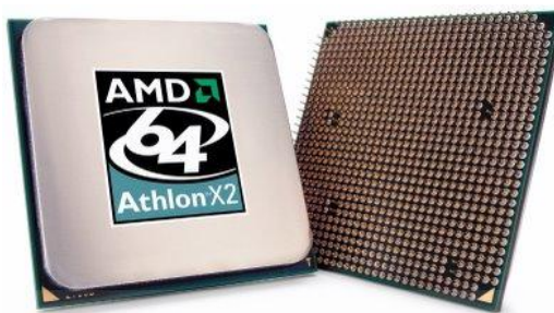
ภาพที่ 6 ลักษณะของบรรจุภัณฑ์ (Packaging) และฐานรอง (Socket) แบบ PGA (Pin Grid Array)
