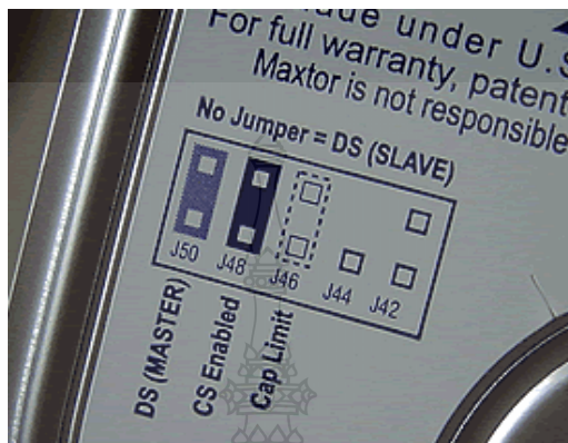
ภาพที่ 9 แสดงการกำหนดการทำงานของอุปกรณ์ออกเป็น Master และ Slave
