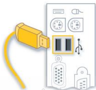
รูปที่ 5 ภาพประกอบของพอร์ตและสายเคเบิล USB หัวไปสายเคเบิลและ USB พอร์ตทั่วไป
