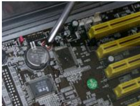
ภาพที่ 6 การขันน๊อต ตามตำแหน่งที่รองด้วยน๊อตหกเหลี่ยม
