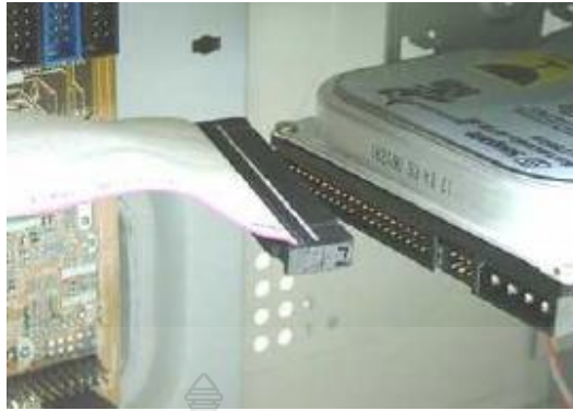
ภาพที่ 14 ต่อสายแพหรือสาย IDE เข้ากับ HDD
