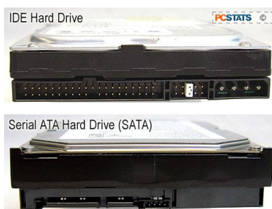
ภาพที่ 4 ความแตกต่าง hard disk แบบ IDE และ SATA
