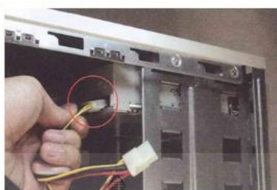
ภาพที่ 22 เสียบสายไฟเข้าที่ด้านหลังของไดร์ฟ CD/DVD
