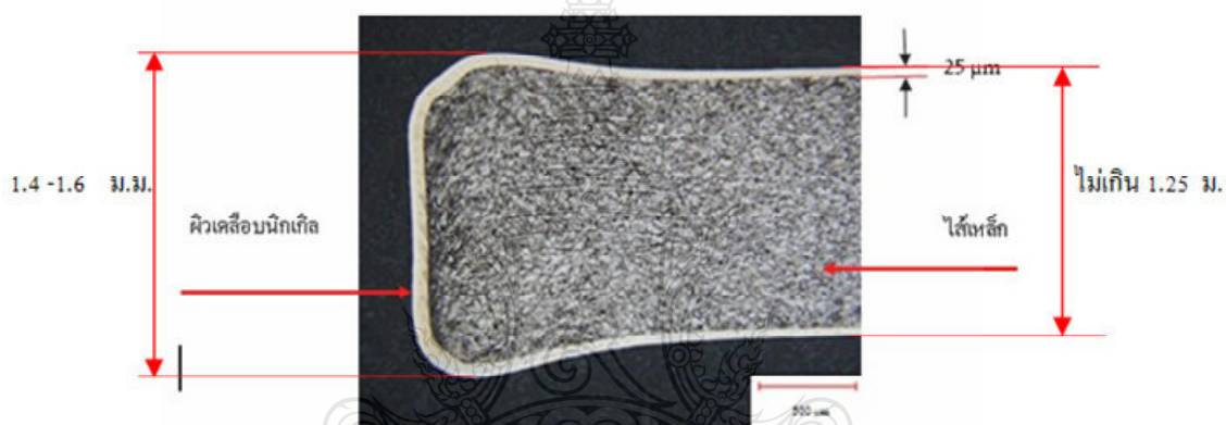
ภาพที่ 2.1 การตัดขวางเหรียญ 1 บาท รุ่นใหม่
