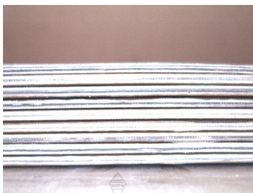
ภาพที่ 3.2 ด้านรอยตัดของกระดาษลูกฟูกชนิด BC
