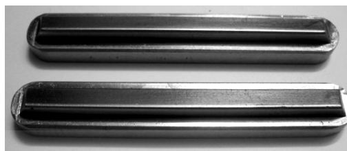
ภาพที่ 3.23 ครอบปิดแบบหน้าตัดสี่เหลี่ยมด้านไม่เท่า (Trapeziform Drawbead)
