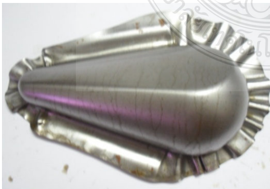
ภาพที่ ค.35 เปรียบเทียบชิ้นงานจริงกับ FEM, Half-Round Drawbead, BHF 30 %, SPCD
