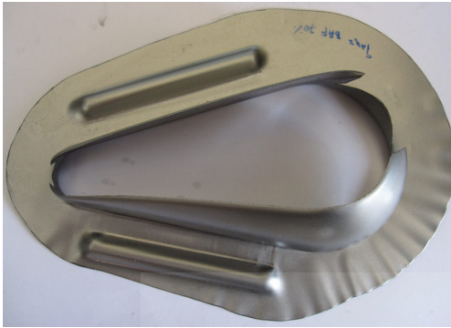
ภาพที่ ค.33 เปรียบเทียบชิ้นงานจริงกับ FEM, Half-Round Drawbead, BHF 70 %, SPCC
