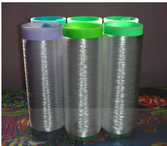
รูปที่ 3.4 ตัวอย่างเส้นด้ายตีเกลียวระหว่างเส้นด้ายไหมกับเส้นด้ายพอลิเอสเตอร์ (50%:50 %)
