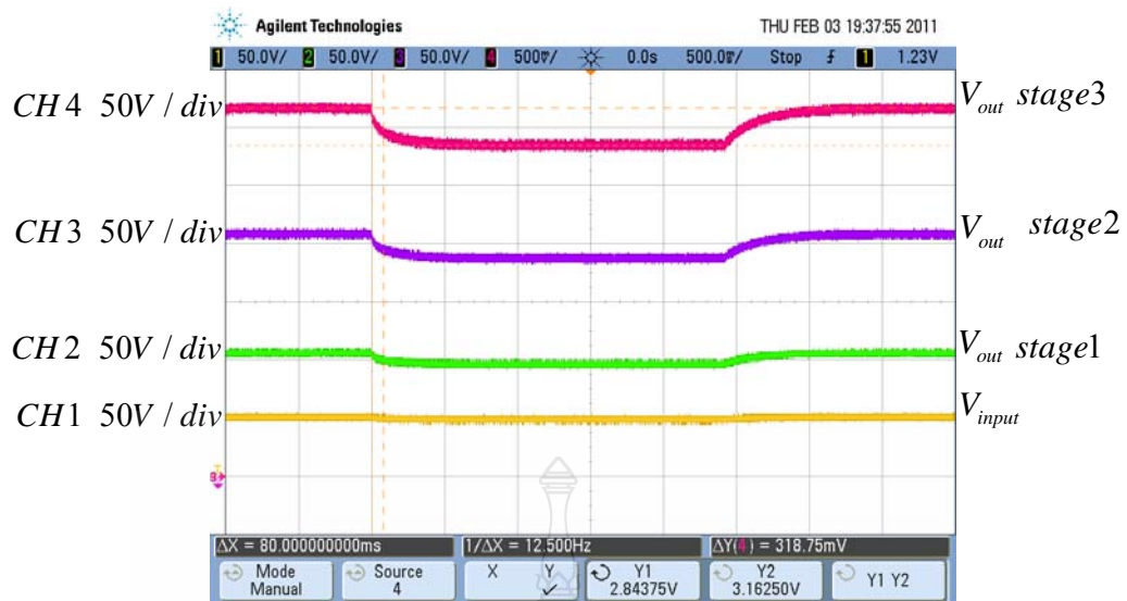
(ข) วงจรทระดับแรงดันไฟฟ้าแบบสามระดับที่ใช้ฮอสซิลโลสโคปวัด ควบคุมแบบวงเปิด
