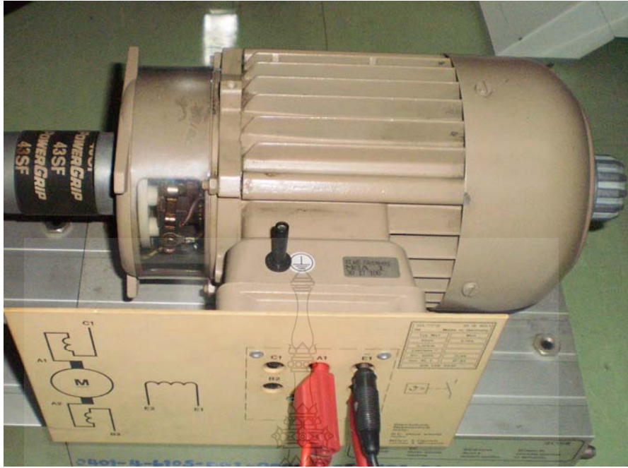
รูปที่ ง.10 เครื่องกำเนิดไฟฟ้ากระแสตรงแบบแยกกระตุ้นขนาด พิกัด 0.37 kW
