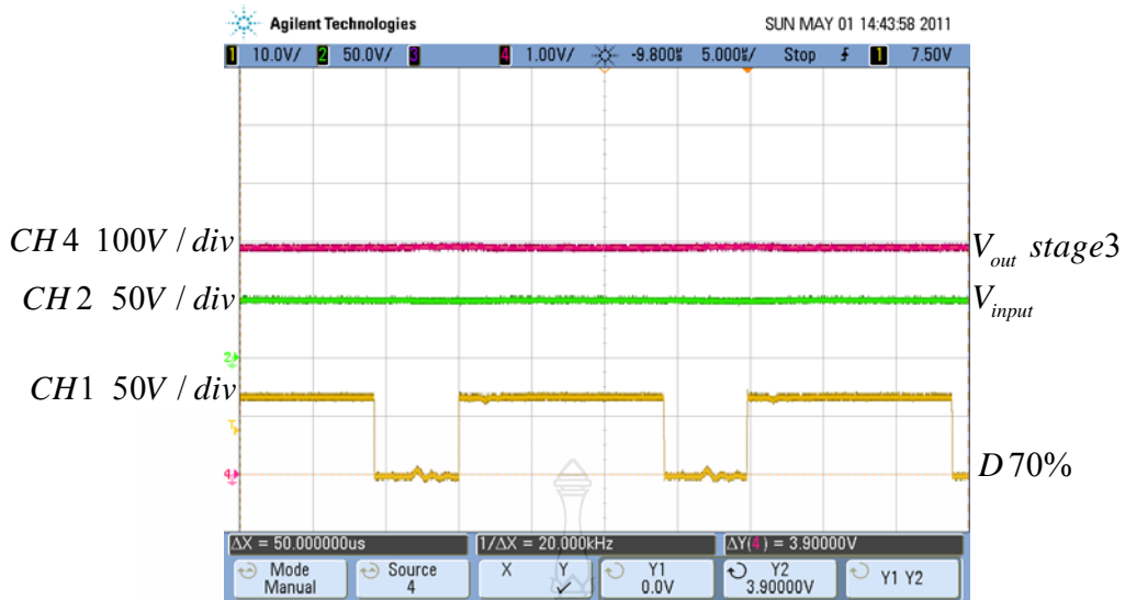
รูปที่ 4.6 สัญญาณแรงดันอินพุตและแรงดันเอาต์พุตที่คิวตี้ไซเคิล 70%
