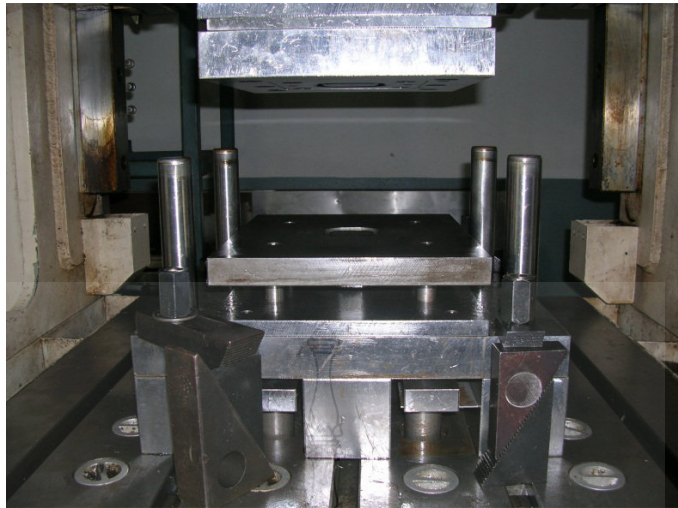
ภาพที่ 3.13 การนำแม่พิมพ์ขึ้นเครื่องปั๊มไฮดรอลิก
