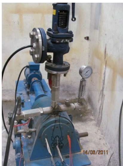
ภาพที่ 4.8 ทดสอบการแมคคานิคอลซีลฝั้แหวนแบบหมุนเพลลา
