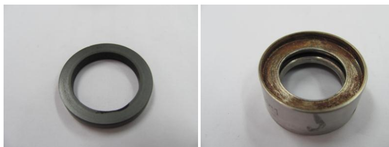
ภาพที่ 1.2 แมคคานิคอลซีลใช้งานที่อุณหภูมิสูงกว่า 100 องศาเซลเซียสแล้วแหวนหลุด
