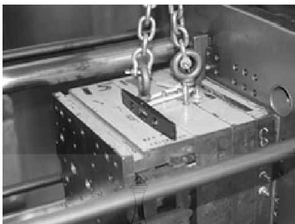
ภาพที่ 4.9 ขั้นตอนการนำแม่พิมพ์ขึ้นติดตั้งยึดกับแท่นเครื่องฉีด
