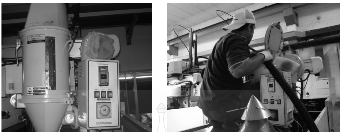
ภาพที่ 4.5 ขั้นตอนการทำความสะอาดหม้ออบ
