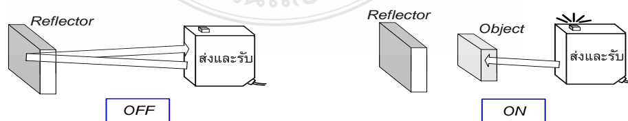
ภาพที่ 2.19 การตรวจจับแบบ Retro-Reflective
