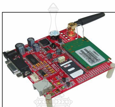
ภาพที่ 2.25 อุปกรณ์รับ-ส่งสัญญาณ GSM/GPRS รุ่น SIM300CZ
