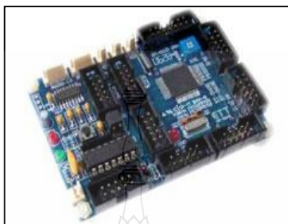
ภาพที่ 2.24 ไมโครคอนโทรลเลอร์ ET-BASE PIC8722
