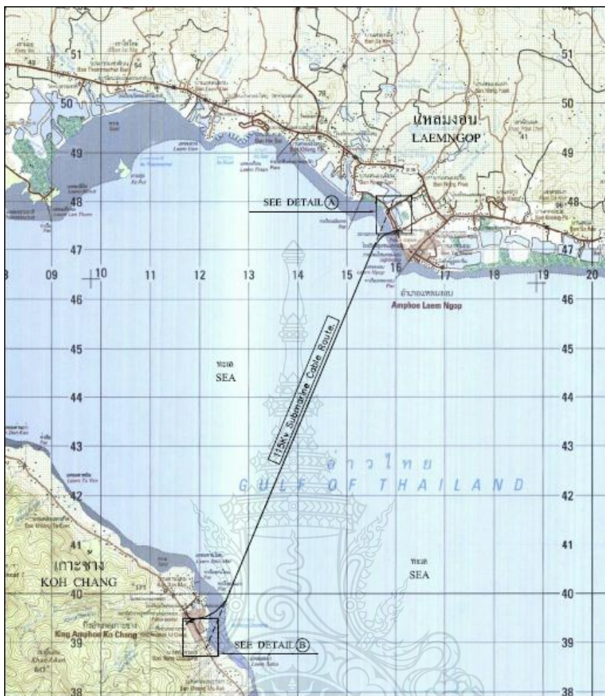
ภาพที่ 3.2 เส้นทางการวางสายเคเบิลใต้น้ำจากฝั่งแผ่นดินใหญ่ อ.แหลมมอบ ไปยังเกาะช้าง
