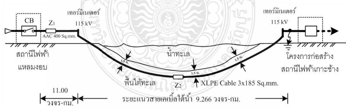
ภาพที่ 3.1 เส้นทางก่อสร้างสายส่ง 115 กิโลโวลต์ จาก สฟ.แหลมมออบ ไปยังเกาะช้าง
