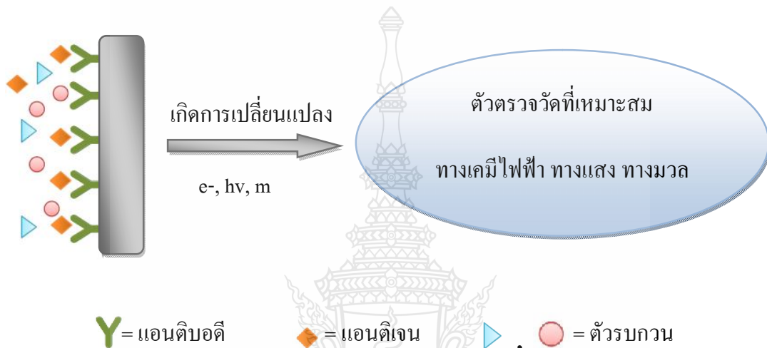
รูปที่ 2.2 การจับกันของแอนติบอดีและแอนติเจน ในเทคนิคอิมมูโนเซนเซอร์ ที่มาของรูปภาพตัดแปลงมาจาก [21]
