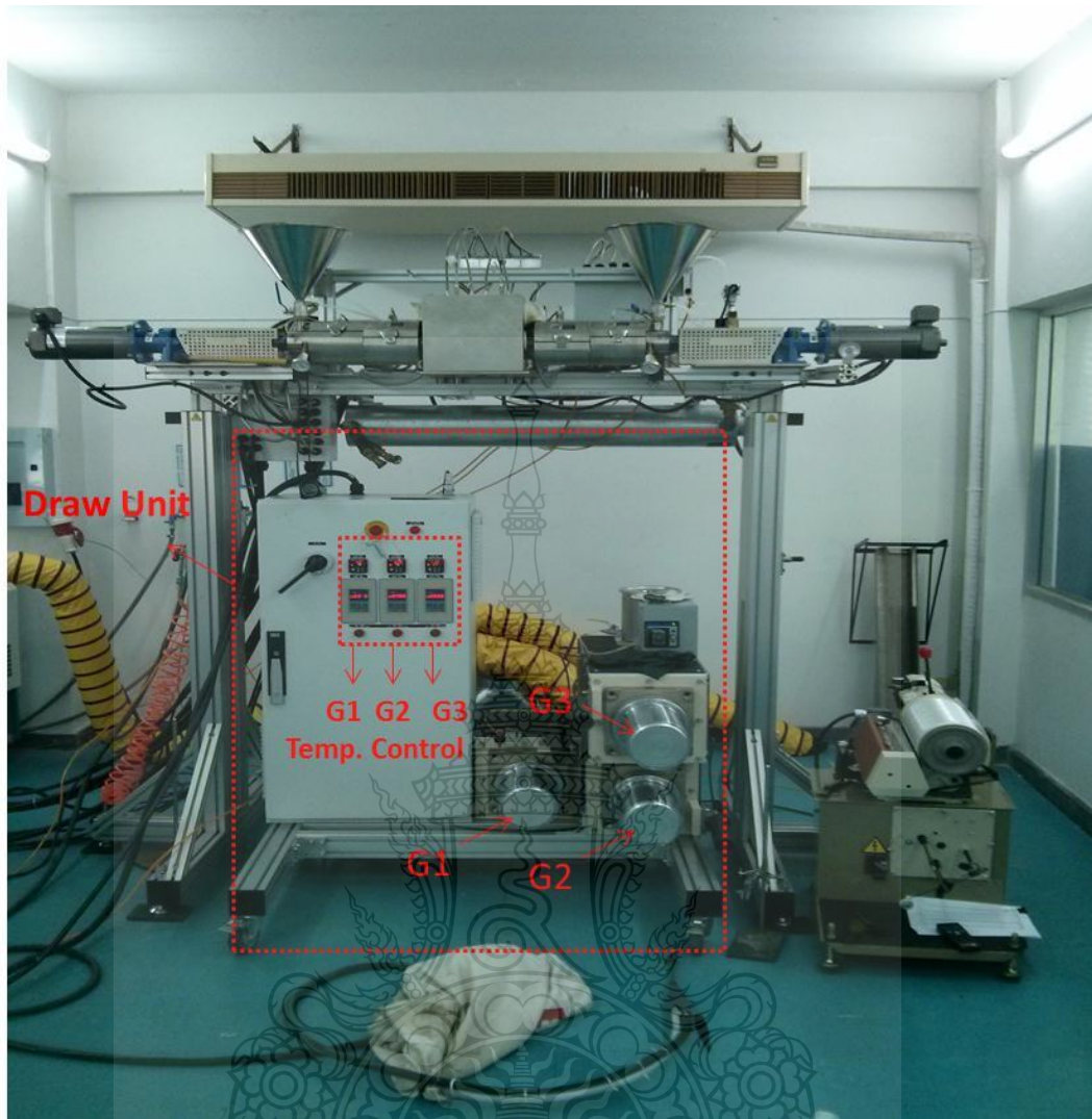
รูปที่ 3.4 Hills: Lab Scale Bicomponent Extruder Fed Spinning Machine Model LBS-100 พร้อมชุดลดขนาด (Draw Unit) และชุดม้วนเก็บ (Widing Unit)
