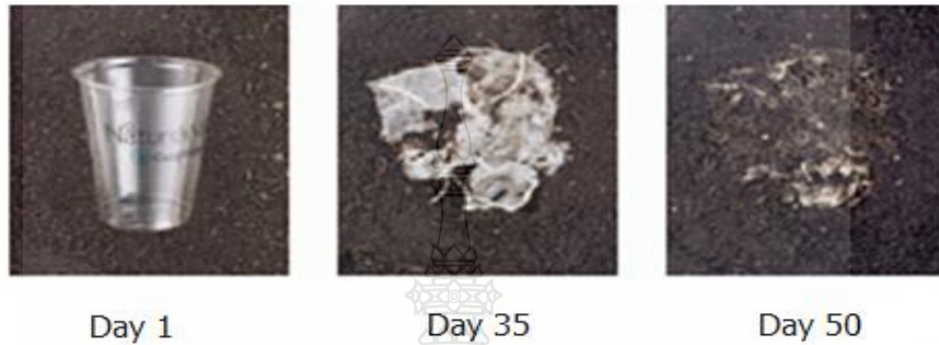
รูปที่ 2.14 ลักษณะการย่อยสลายของพอลิแลคติกแอซิด [17]
