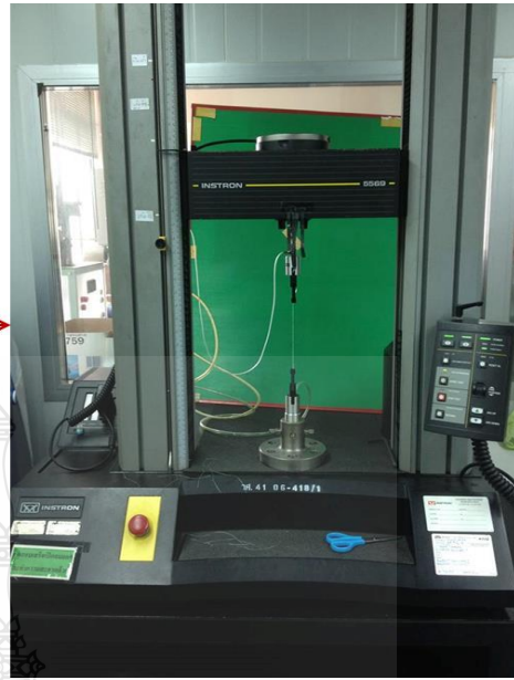
รูปที่ 3.7 เครื่องทดสอบความทนทานต่อแรงดึงและแบบตัดชิ้นงาน (Template)
