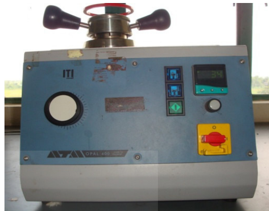
รูปที่ 3.15 เครื่องหล่อตัวเรือนชิ้นงาน
