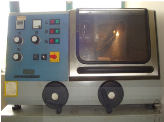
รูปที่ 3.14 เครื่องตัดชิ้นงานตัวอย่าง
