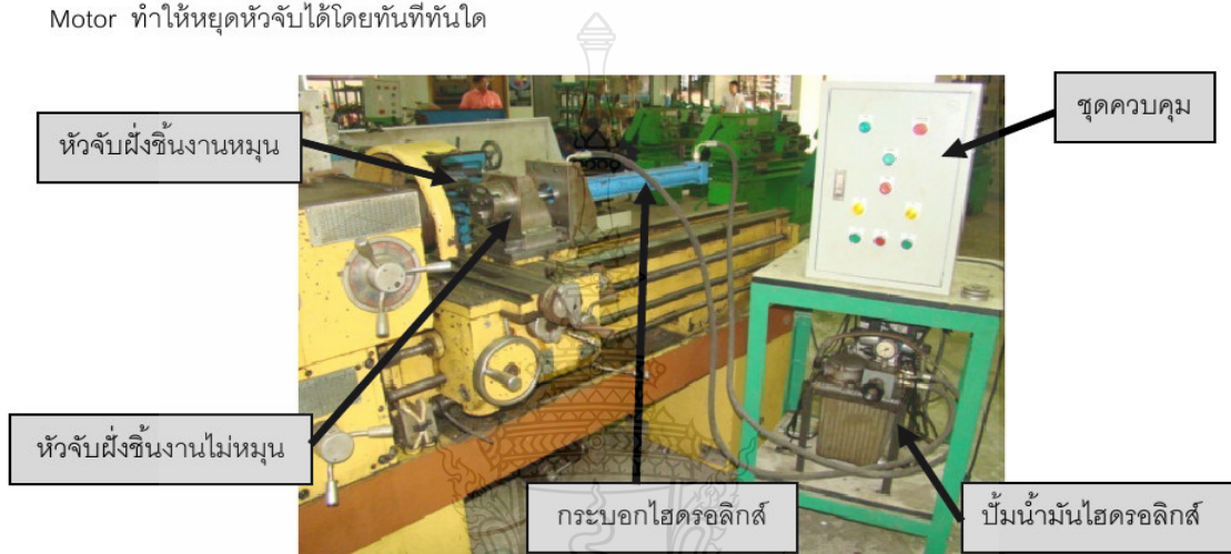
รูปที่ 2 เครื่องเชื่อมด้วยความเสียดทาน
