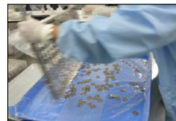
รูปที่ 11 การนำชิ้นงานออกจากอุปกรณ์จับยึดด้วยวิธีการเทชิ้นงาน(หลังการปรับปรุง)
