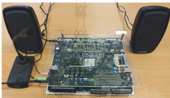
รูปที่ 6 การพัฒนาเทคนิคสำหรับการแยกแยะเสียงโฆชะและเสียงอโฆชะบนบอร์ดเอฟพีจีเอ Virtex-II Pro (XC2VP30)
