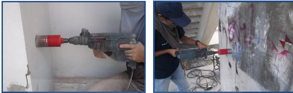
รูปที่ 3.8 การเจาะเก็บตัวอย่างคอนกรีตด้วยส่วนหัวเจาะแบบ Hole Saw
