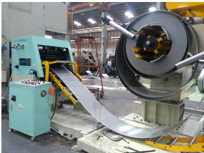
ภาพที่ 3.8 การนำโลหะแผ่นหรือเหล็กม้วนมาผ่านกระบวนการตัด
