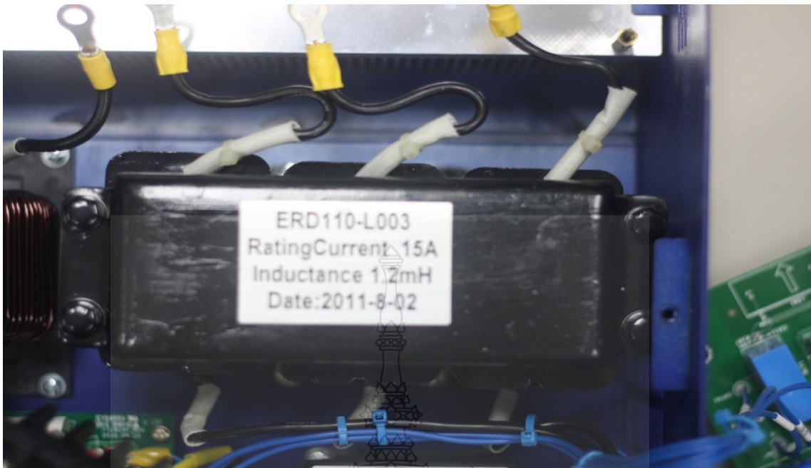
10. อินดักเตนซ์ที่ใช้งานฝั่งขาออกเพื่อรองความถี่
