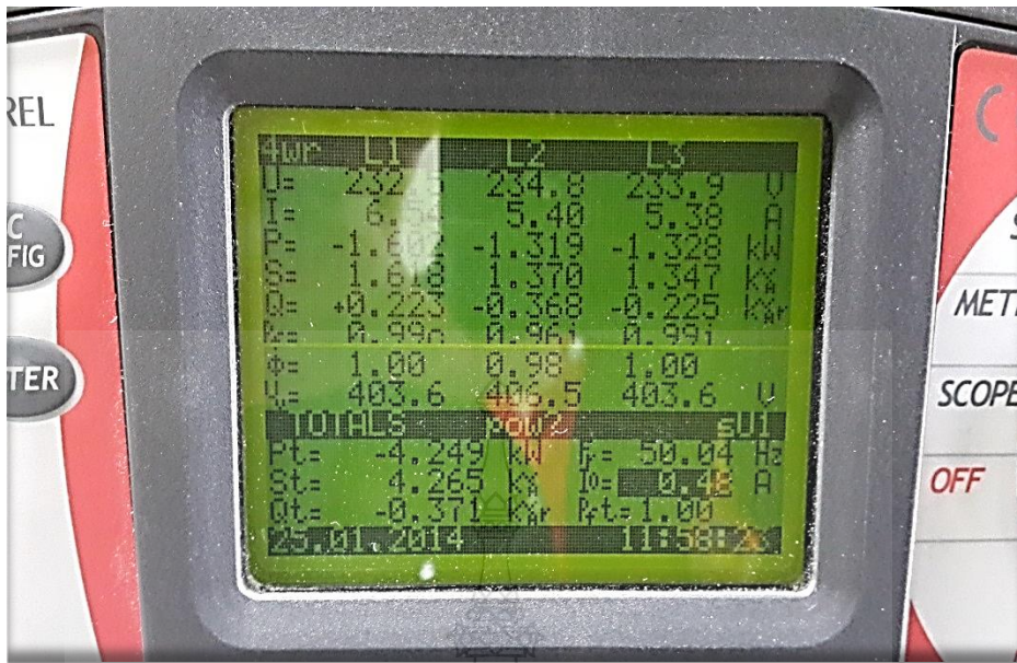
รูปที่ 4.27 พลังงานไฟฟ้าขณะทีลฟต์เคลื่อนที่ใช้เครื่องวัดพลังงาน(มิเตอร์รุ่น MI 2292)
