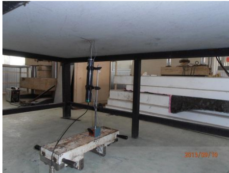
(ก) ติดตั้ง LVDT ที่ใต้กึ่งกลางแผ่น
