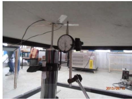
(ข) ติดตั้ง Dial Gauge
