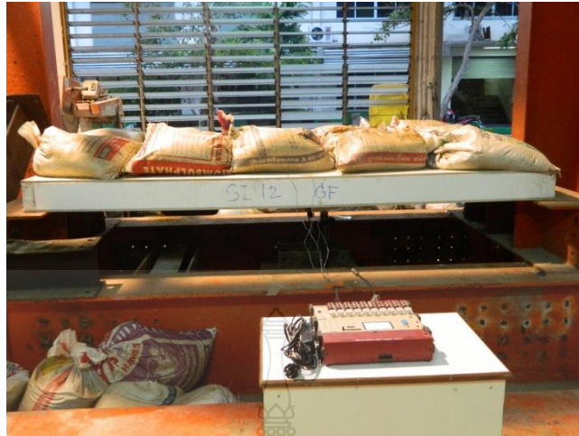
รูปที่ 3.28 การวางกระสอบบรรจุทรายบนแผ่นวัสดุทดสอบ
