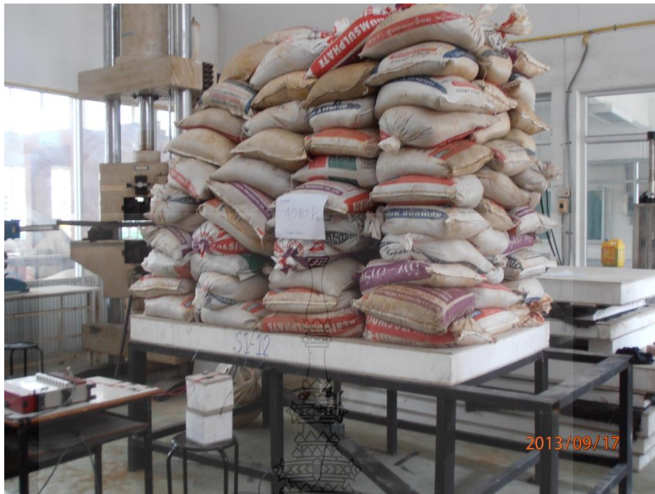
รูปที่ ก.32 ทดสอบแผ่นพื้น SI-14-FT Two Way Slab โดยการใส่น้ำหนักสูงสุด
