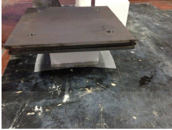
รูปที่ 3.8 ให้นำน้ำหนักกดทับแผ่น SIP จนกว่ากาวจะแห้ง
