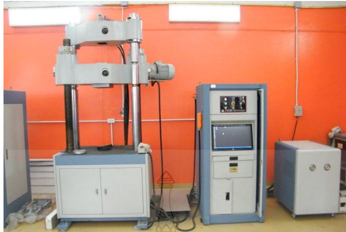
รูปที่ 3.17 เครื่องทดสอบ Universal Testing Machine ขนาด 100 ตัน
