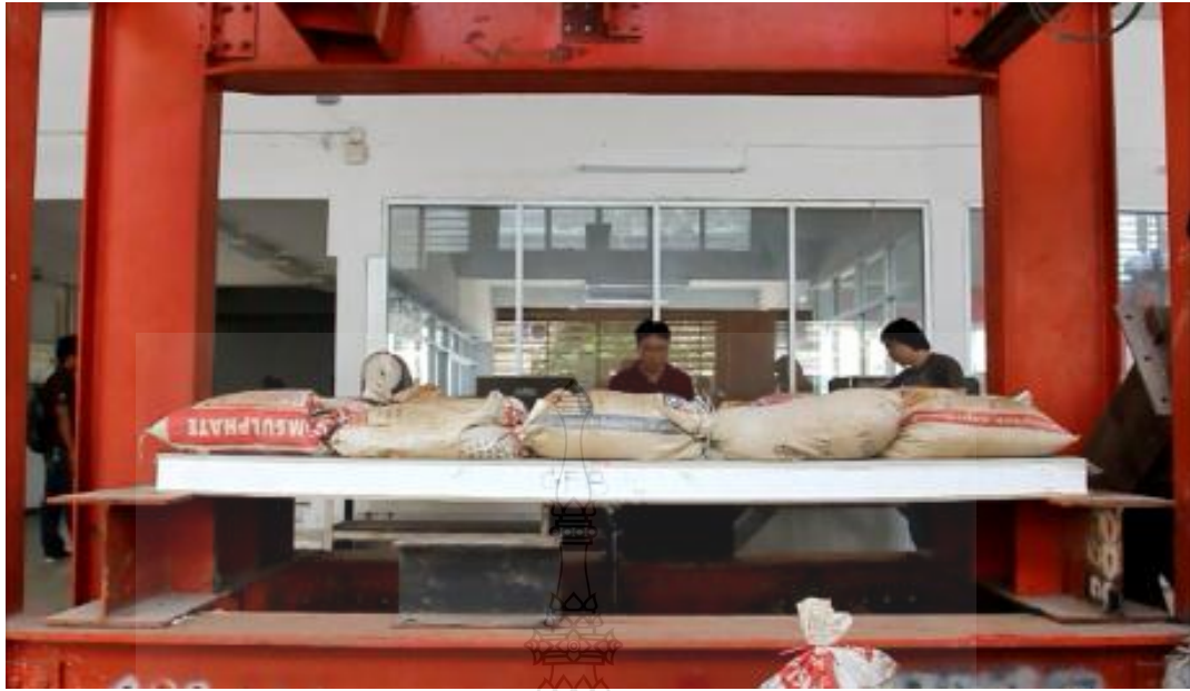
รูปที่ ก.21 แผ่นพื้น GF-10-FT โดยวางถุงทรายชั้นแรกบนแผ่น
