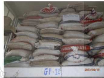
รูปที่ 11 การทดสอบให้น้ำหนักกับแผ่นพื้น SIP GF-14-FT
