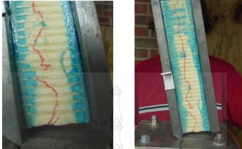
รูปที่ 2.18 แผ่นวัสดุลูกฟูกใยแก้วสามมิติเสริมโพลีเมอร์แนวตั้งทดสอบแรงเฉือน [15]
