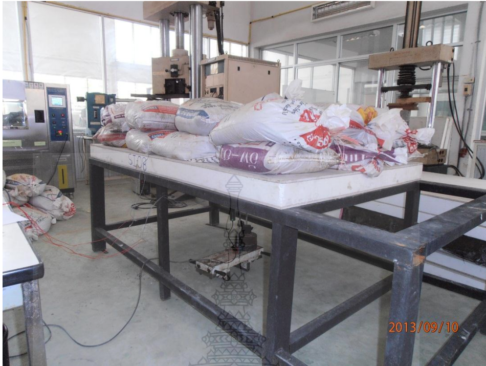
รูปที่ ก.30 ทดสอบแผ่นพื้น SI-10-FT Two Way Slab โดยการใส่น้ำหนัก
