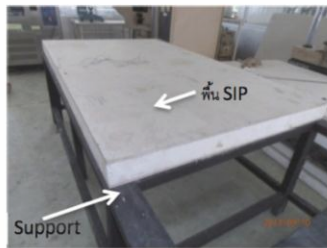
รูปที่ 4 ลักษณะของกรวางแผ่นพื้น SIP บนโต๊ะทดสอบ
