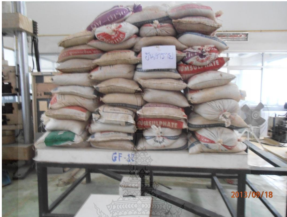
รูปที่ ก.34 ทดสอบแผ่นพื้น GF-14-FT Two Way Slab โดยการใส่น้ำหนักสูงสุด
