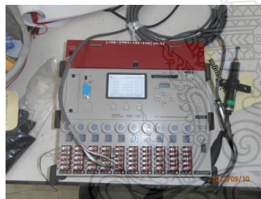
รูปที่ 3.22 เครื่อง Data Logger แสดงผลการโก่งตัวและการขีดหดตัวเมื่อใส่น้ำหนักลงบนแผ่นวัสดุทดสอบ
