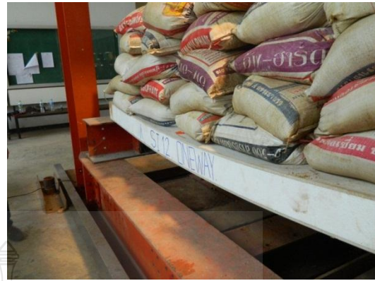
(ข) แผ่นSIP โกงตัวเมื่อรับน้ำหนัก
