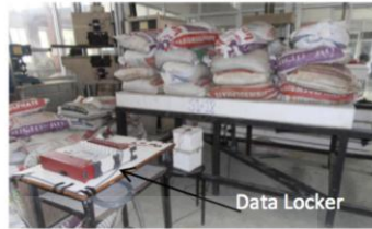
รูปที่ 7 การทดสอบให้น้ำหนักกับแผ่นพื้น SI-10-FT ที่ละชั้น
