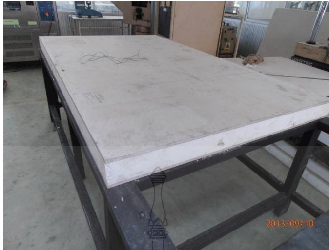
รูปที่ 3.18 ฐานเหล็กรองรับแผ่นพื้น Two Way Slab ใช้รับน้ำหนักแบบแรงคัต Full Scale
