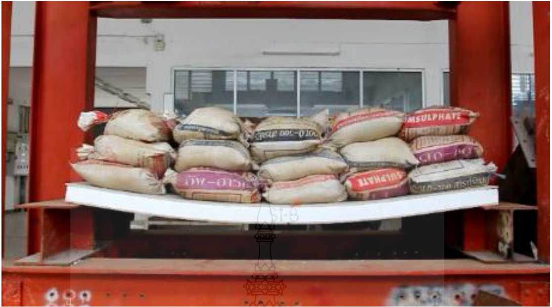
รูปที่ ก.19 แผ่นพื้น SI-10 FT หลังจากวางถุงทรายชั้นที่ 3 (ต่อ)
