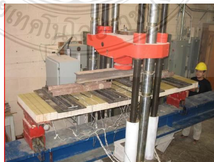
รูปที่ 2.13 การทดสอบแผ่นตัวอย่างที่เสริมโครงคร่าด้านนอกและด้านใน [12]
