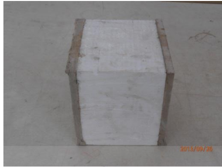
รูปที่ 4.5 ลักษณะการวิบัติของชิ้นตัวอย่าง SI-14-CT เนื่องจากแรงอัด
