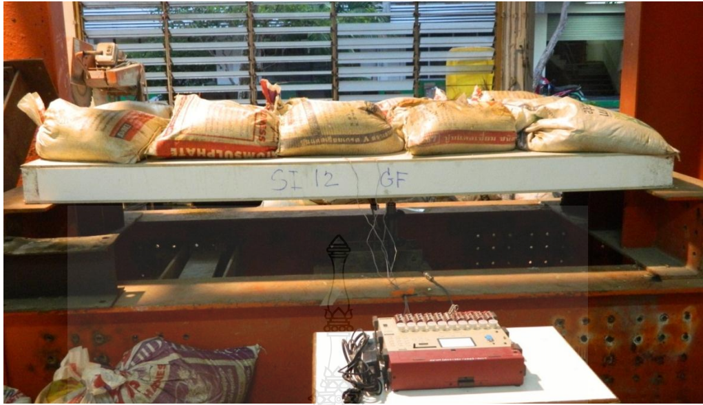
รูปที่ ก.15 ทำการทดสอบแผ่นพื้น GF-14-FT โดยวางถุงทรายชั้นแรกบนแผ่น
