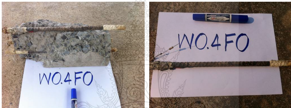
รูปที่ 4.10 ลักษณะเหล็กเสริมที่เกิดสนิมจากการทดสอบชนิดที่ใช้เหล็กเคลือบฟอสเฟต
