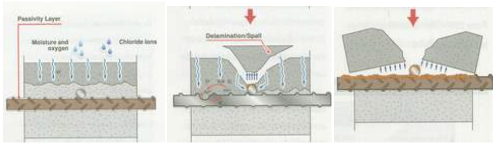
รูปที่ 2.2 กระบวนการเกิดสนิมของเหล็กเสริมเนื่องจากคลอไรด์ในน้ำทะเลหรือน้ำกร่อย [9]
