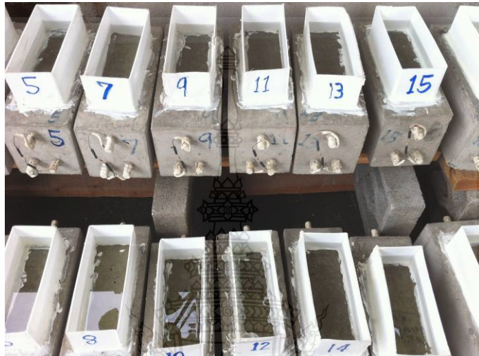
รูปที่ 3.13 การขังสารละลายโซเดียมคลอไรด์เข้มข้น 10 %
