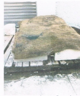
รูปที่ 4 การบ่มโดยใช้กระสอบที่ชุ่มด้วยน้ำคลุมที่ตัวอย่างคอนกรีต
