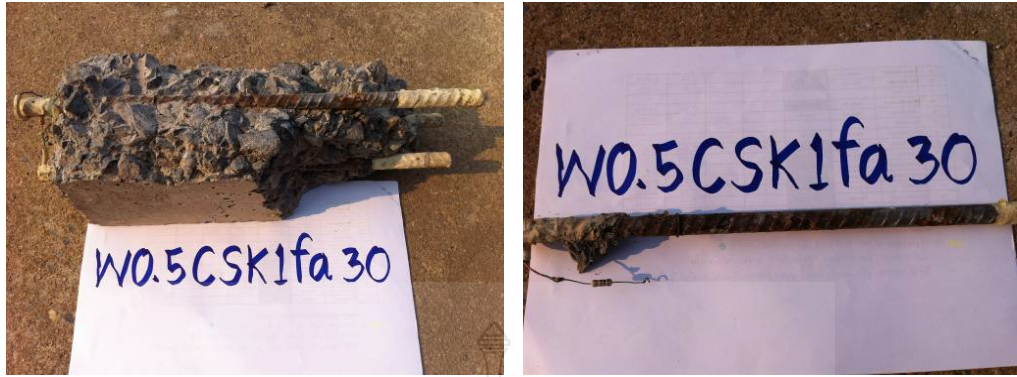
รูปที่ 4.12 ลักษณะเหล็กเสริมที่เกิดสนิมจากการทดสอบชนิดใช้สารยับยั้งชนิดทาที่ผิว
