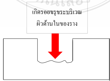
รูปที่ 3.23 ลักษณะของราง ที่ผิวภายในเกิดการขรุขระ
