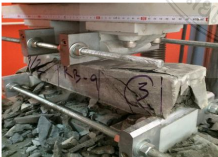
รูปที่ 4.16 แสดงการทดสอบและผลจากการทดสอบแรงดัด C-RB 9, C1S-RB 9, C2S-RB 9
