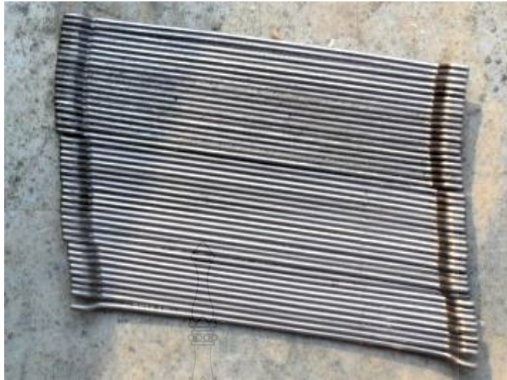
รูปที่ 2.1 การเรียงตัวแบบเป็นระเบียบ (Continuous Reinforcement)
