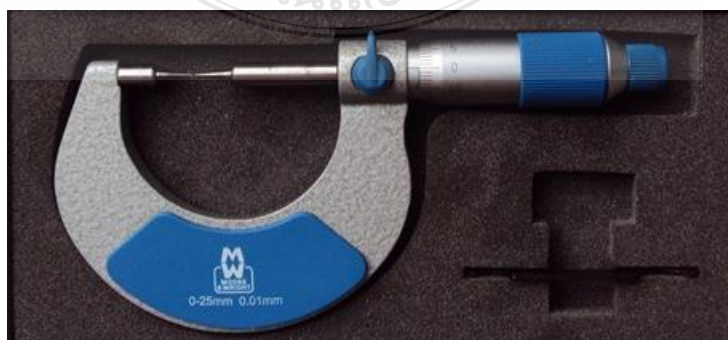
รูปที่ 3.22 ไมโครคาลิปเปอร์สำหรับวัดความหนาขึ้นงาน
