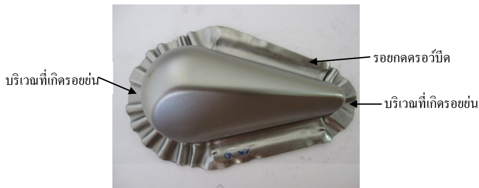
รูปที่ 4.16 ชิ้นงานใช้ครอว์บีคเสริมแรงยางสังเคราะห์ แรงกดชิ้นงาน 30 เปอร์เซ็นต์
