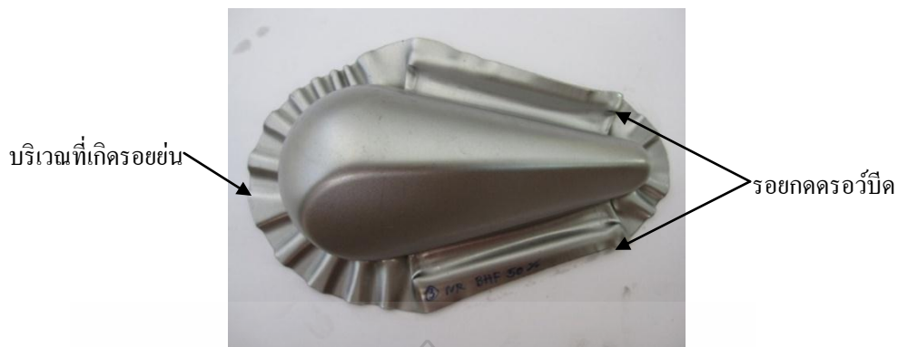
รูปที่ 4.14 ชิ้นงานใช้ครอว์บีคเสริมแรงยางธรรมชาติ แรงกดชิ้นงาน 50 เปอร์เซ็นต์
