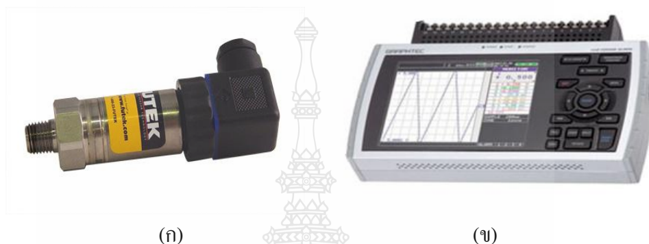
รูปที่ 3.25 (ก) อุปกรณ์วัดแรงดันน้ำมัน (ข) อุปกรณ์จัดเก็บสัญญาณ
