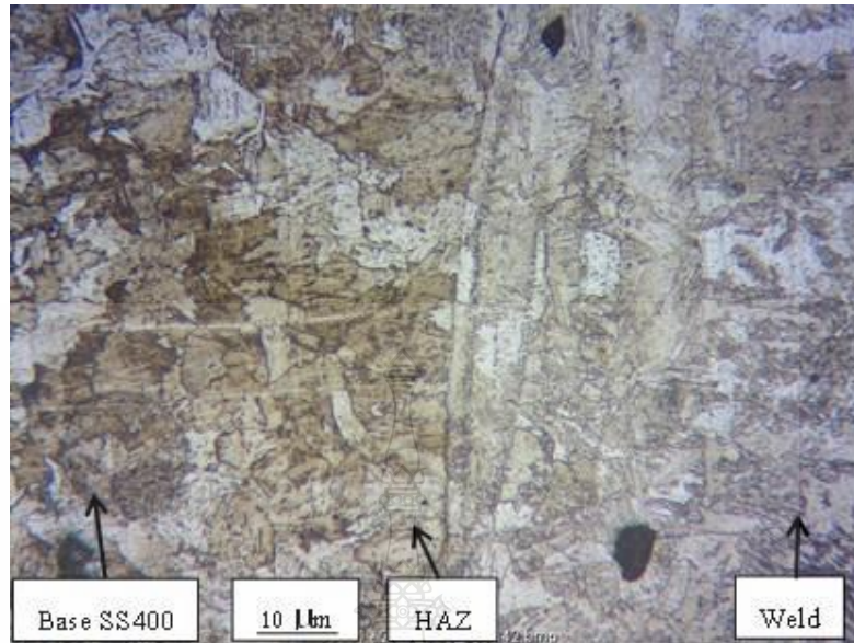
รูปที่ 4.31 ลักษณะโครงสร้างบริเวณแนวเชื่อมกับพื้นที่ที่กระทบร้อนด้านเหล็กกล้าคาร์บอน SS400 ที่ กระแส 110 A ความเร็ว 400 มม./นาที แกสปกคลุม CO 2 100%
