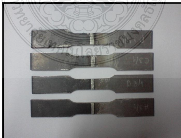
รูปที่ 3.18 ลักษณะชิ้นงานทดสอบแรงดึงเมื่อผ่านการกัดด้วยเครื่องจักร
