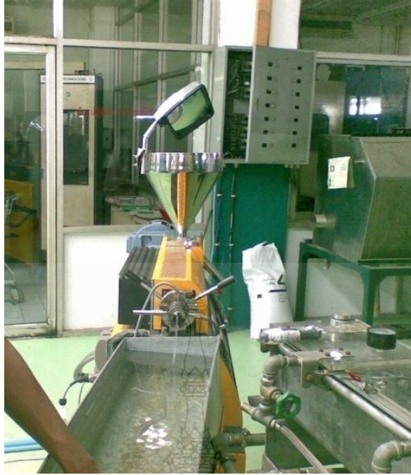
รูปที่ ก.5 เส้นพอลิเมอร์ผสมที่ผ่านจากเครื่อง Single Screw Extruder ถูกทำให้เย็นตัวในน้ำ
