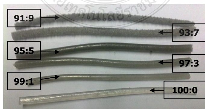
รูปที่ ก.15 เส้นพอลิเมอร์ผสมที่ได้จากการผสมในเครื่องอัดรีดแบบเกลียวหนอนเดี่ยว
