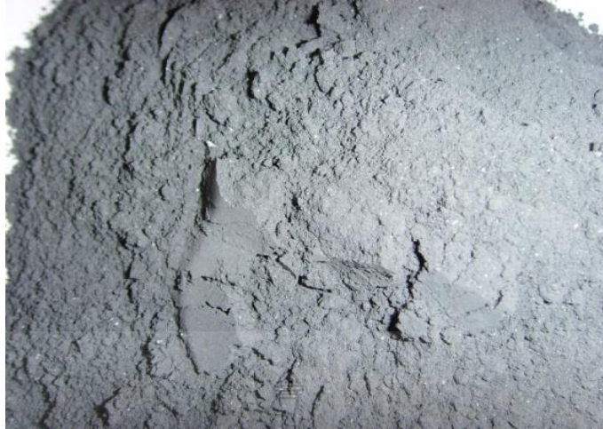
รูปที่ 3.9 ซีตระกันอะลูมิเนียมที่ได้จากการบดและคัลดขนาด
