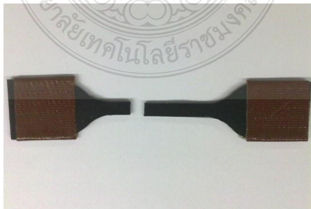
รูปที่ 3.30 ชิ้นงานทดสอบจากการทดสอบแรงดึง
