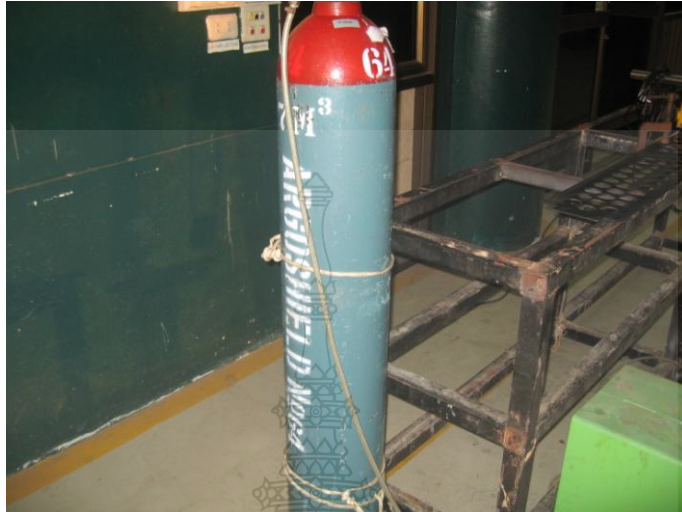
รูปที่ 3.2 แก๊สปกคลุมอาร์โกซิล 64 ที่ใช้ในการเชื่อม
