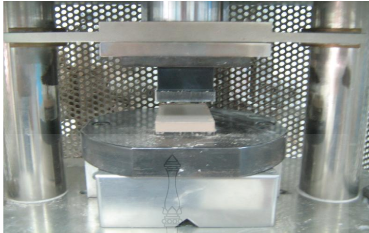
รูปที่ 3.16 การขึ้นรูปกระเบื้องด้วยเครื่องอัดไฮดรอลิค
