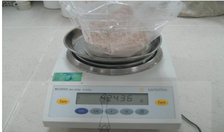
รูปที่ 3.14 การชั่งน้ำหนักหาปริมาณการควบคุมควบคุมความชื้นของผงดิน
