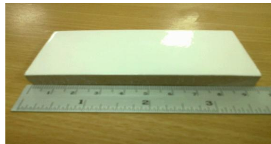
รูปที่ 1 กระเบื้องบุผนังภายในที่มีส่วนผสมของตะกอนดินเซรามิก
