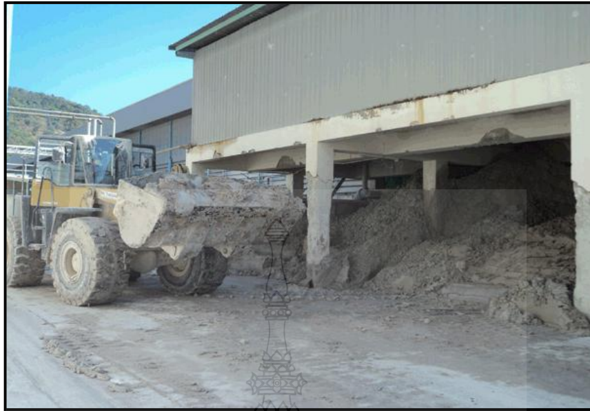
รูปที่ 2.1 ตะกอนดินเซรามิกที่ได้จากกระบวนการผลิตกระเบื้องเซรามิก
