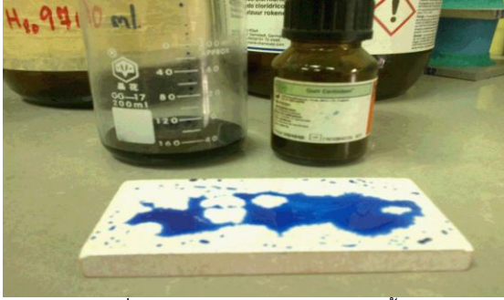
รูปที่8 การทดสอบการรานของกระเบื้อง
