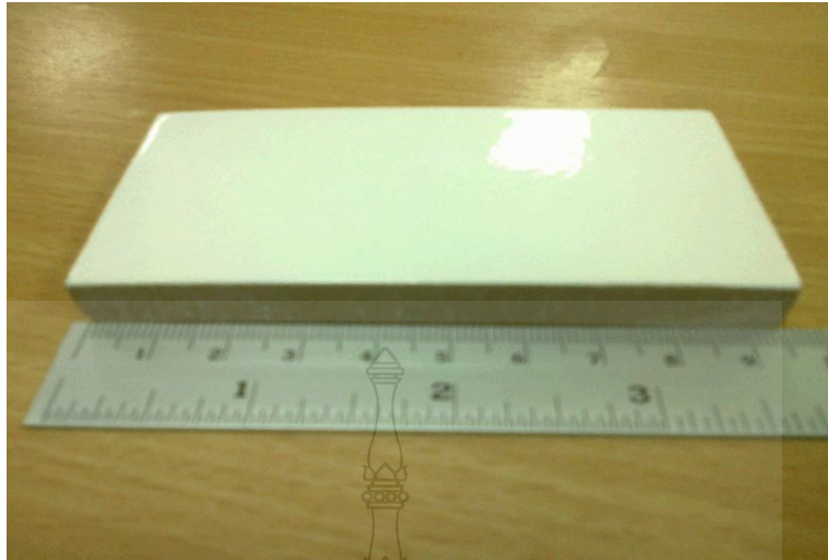
รูปที่ 3.20 กระเบื้องปูผนังที่มีส่วนผสมของตะกอนดินเซรามิก
