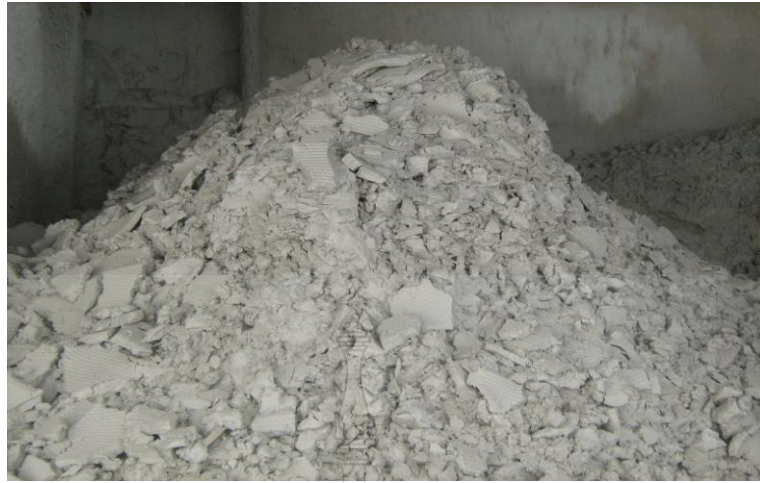
รูปที่ 3.1 ตะกอนดินเซรามิกจากกระบวนการผลิตกระเบื้องเซรามิก
