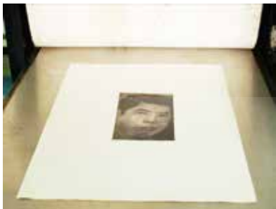
ภาพที่ 14 การวางแม่พิมพ์บนแท่นพิมพ์
