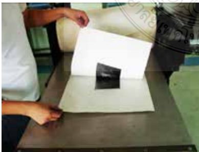
ภาพที่ 19 การเปิดกระดาษพิมพ์งานจากแท่นพิมพ์
