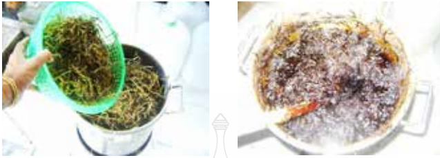
ภาพที่ 4 กระบวนการลวกเยื่อเศษวัชพืชเพื่อให้ได้เยื่อไม้ สำหรับการขึ้นรูปผลิตภัณฑ์ต่างๆ
