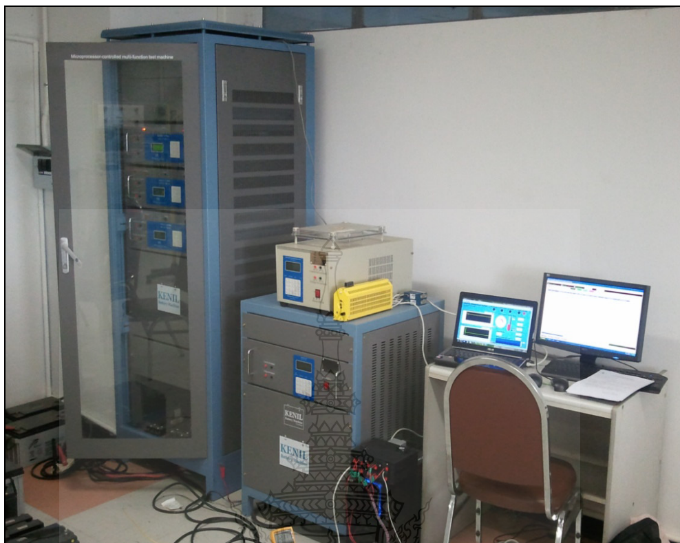
ภาพที่ 3.9 การทดสอบค่าสภาวะประจุเปรียบเทียบ MTB กับ LabVIEW ในห้องปฏิบัติการ มทร. รัตนบุรี
