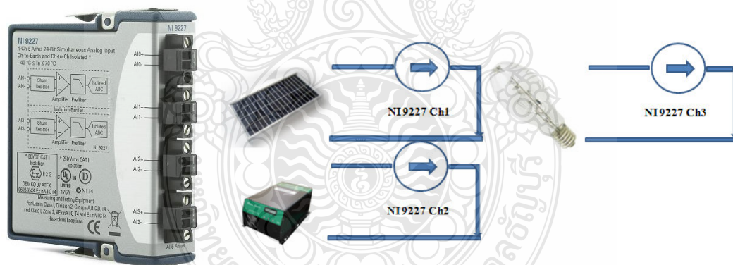
ภาพที่ 3.13 NI 9227 ใช้วัดระดับกระแสไฟฟ้า
