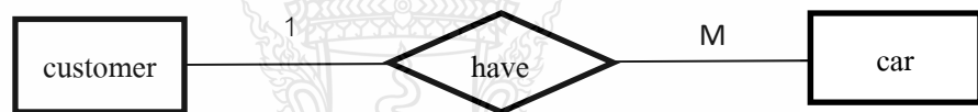
ภาพที่ 4.29 แสดงความสัมพันธ์ระหว่างลูกค้ากับรถยนต์ ลูกค้าหนึ่งคนมีรถยนต์ได้หลายคัน และรถแต่ละคันมีเจ้าของหนึ่งคน
